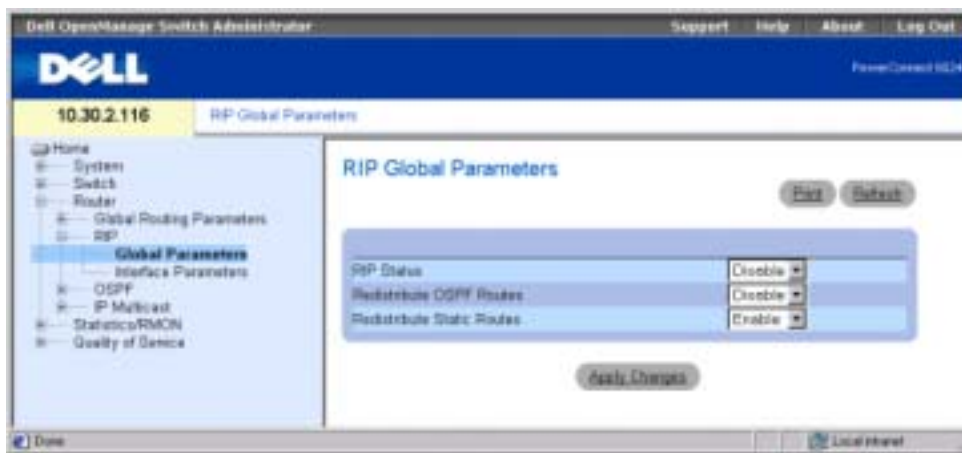
Figure 8-8. RIP Global Parameters Page
